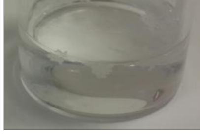
Şekil 3. 2: 100 ml çözelti için THF/DMF oranı 8/2 olan PVDF + THF/DMF çözeltisi.
