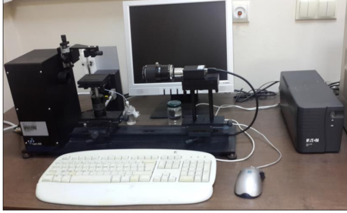
Şekil 3.13: 4 KSV CAM 200 model temas açısı cihazı.
