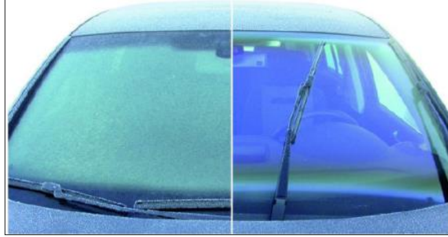
Şekil 2.43: Camında buz önleyici kaplama olan tarafı buzlanmayan fakat kaplama olmayan tarafı buzlanan araba.
