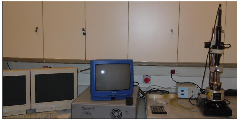
Şekil 3.12: Digital Instruments NanoScope IV model atomik kuvvet mikroskobu.
