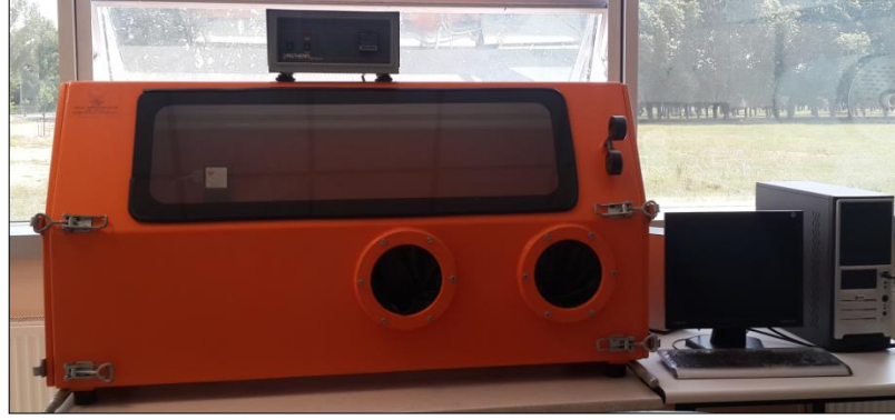
Şekil 3.7: Terralab model daldırmalı kaplama cihazı.
