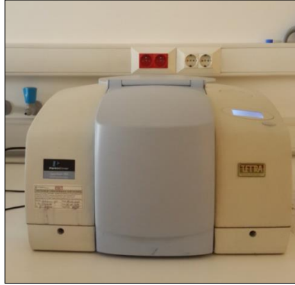
Şekil 3.11: Perkin Elmer Spectrum 100 model FT-IR spektrometresi.
