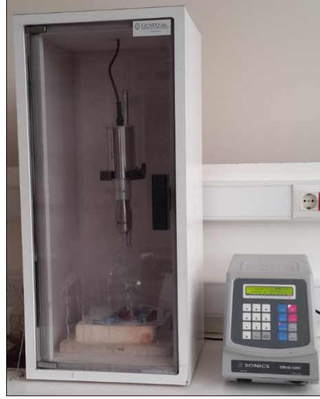
Şekil 3.5: Sonics Vibra-Cell VC 750 model ultrasonik karıştırıcı.
