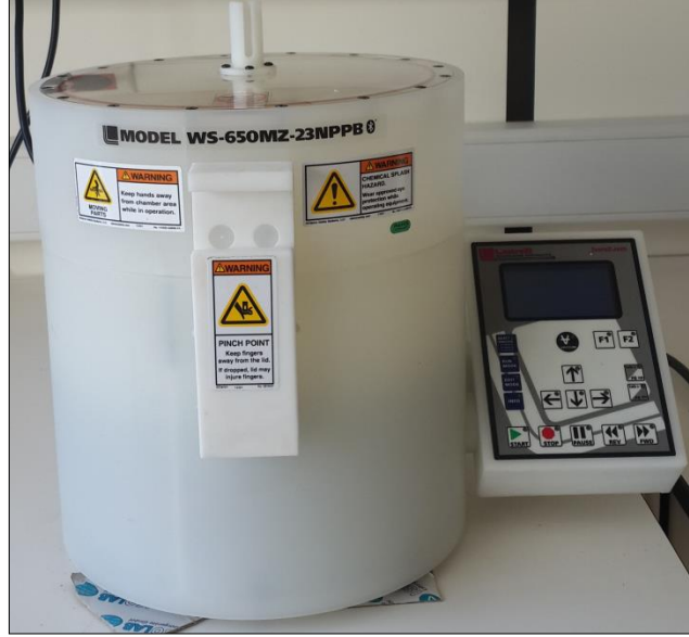
Şekil 3.6: Laurell WS-650-23B model döndürmeli kaplama cihazı.
