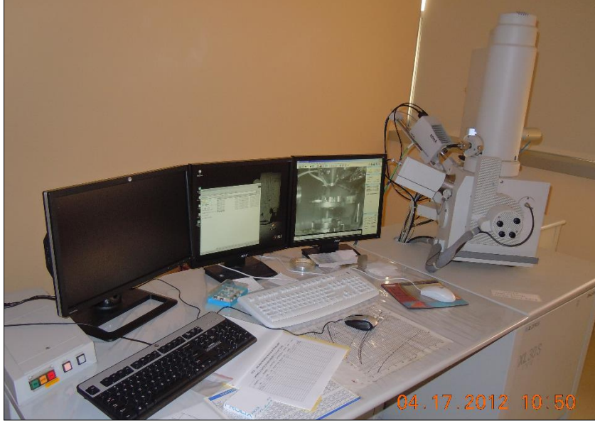
Şekil 3.10: Philips marka XL30-SFEG model taramalı elektron mikroskobu.
