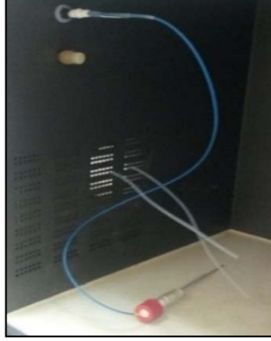
Şekil 7.5: Kapiler cam kılıflı FO sensör.
