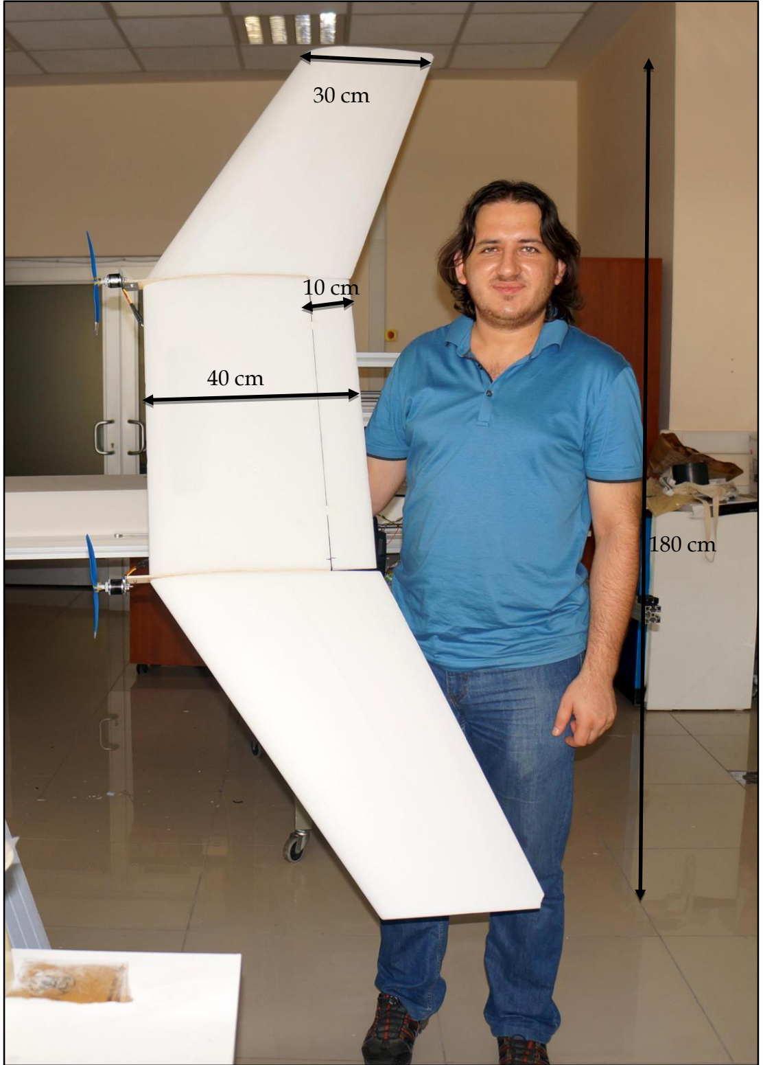
Şekil 5.16: İHA üst kanat ölçüleri.
