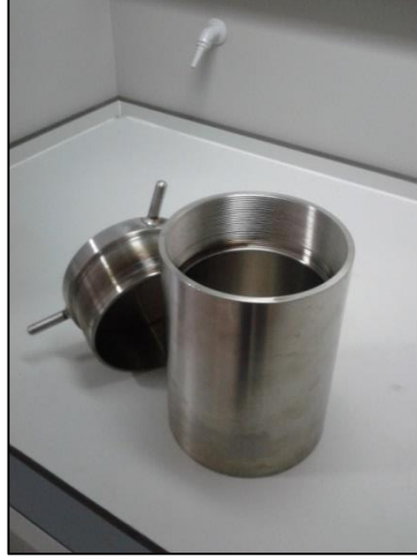
Şekil 3.1: Toz sentezinde kullanılan özel üretim çelik reaktör.
