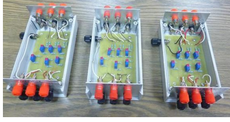
Şekil 4.10: Gerçekleştirilen gerilim şartlandırıcılar.
