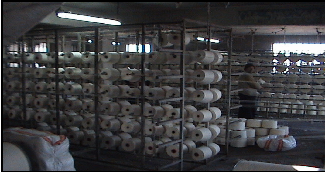
Fotoğraf 35: Haşılhanede İpliklerin Çözüğü Çağılısına Takılması.
