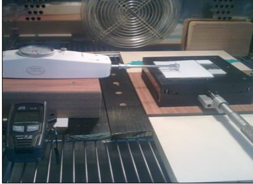
Şekil 5.15: Buz yapışma testlerinde kullanılan sistem.
