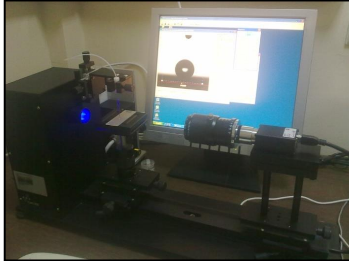
Şekil 5.8: Temas açısı ölçümlerinde kullanılan KSV CAM 200 cihazı.
