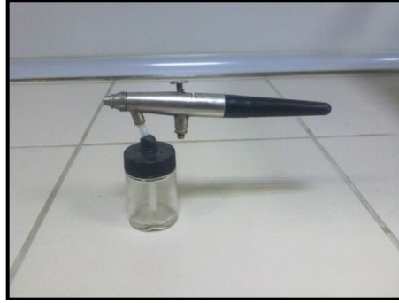
Şekil 5.4: Püskürtmede kullanılan Badger 175 Airbrush model el spreyi.
