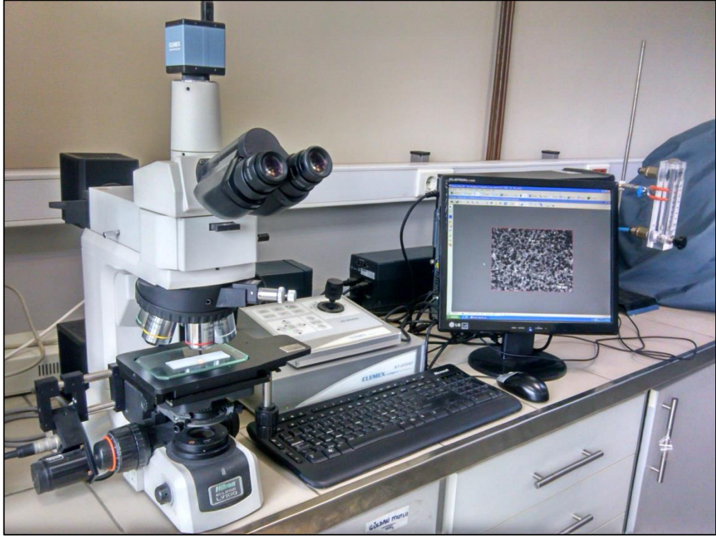
Şekil 5.9: Yüzeylerin fotoğraflanmasında kullanılan optik mikroskop.
