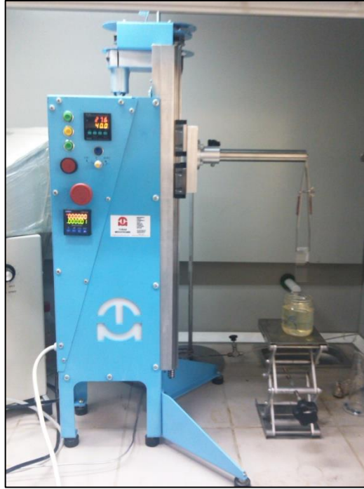
Şekil 5.7: İnce film kaplamak için kullanılan dipper cihazı.
