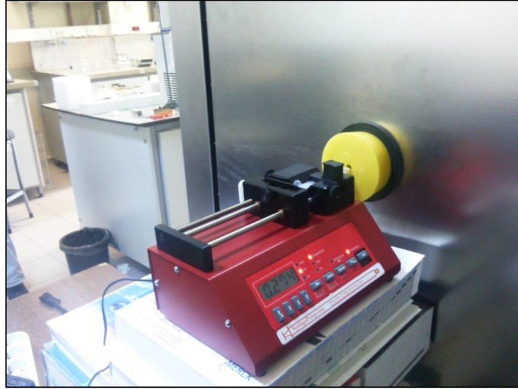
Şekil 5.17: İklimlendirme kabini içerisindeki yüzeyler üzerinde su damlası oluşturmak için kullanılan şırınga pompası.
