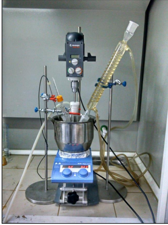
Şekil 5.6: Reaksiyonlarda kullanılan çözelti polimerizasyon sistemi.
