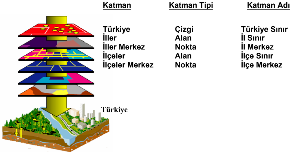
Şekil 1: Türkiye Tarım Coğrafyası Veri Tabanında Bulunan Grafik Verilere Ait Katman, Katman Tipi ve Katman Adları
