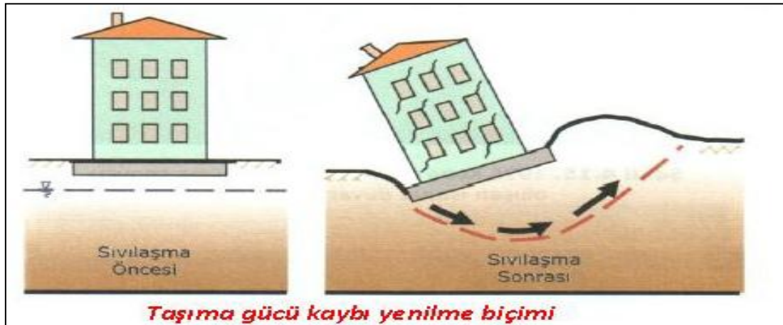
Şekil 2.20: Taşıma gücü kaybı oluşum şeması.
