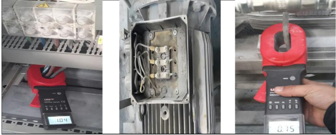
a) Panodan ölçüm. b) Motor bağlantısı. c) Motor üzerinden ölçüm.
