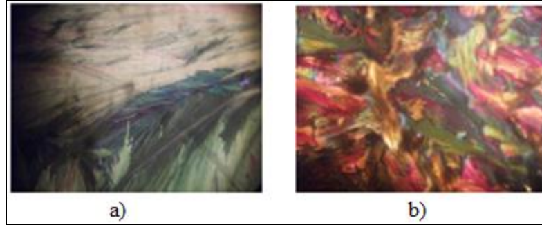
Şekil 3.32: 14 nolu ftalosiyanın bileşiğinin kristalden kristale geçişine ait POM fotoğrafları. a) 136^{\circ}\text{C} , b) 151^{\circ}\text{C} .
