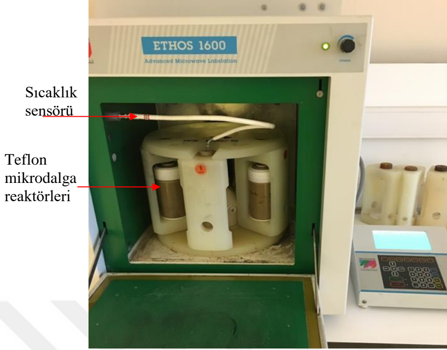
Şekil 3.4: Mikrodalga destekli in-situ transesterifikasyon deneylerinde kullanılan mikrodalga fırını ve deney düzeneği.
