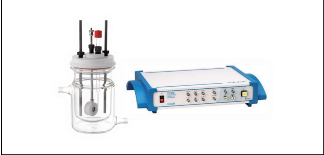
Şekil 3.3: GTÜ Malzeme Mühendisliği laboratuvarındaki VoltaLab PGZ402 model potansiyometre cihazı ve test hücresi.
