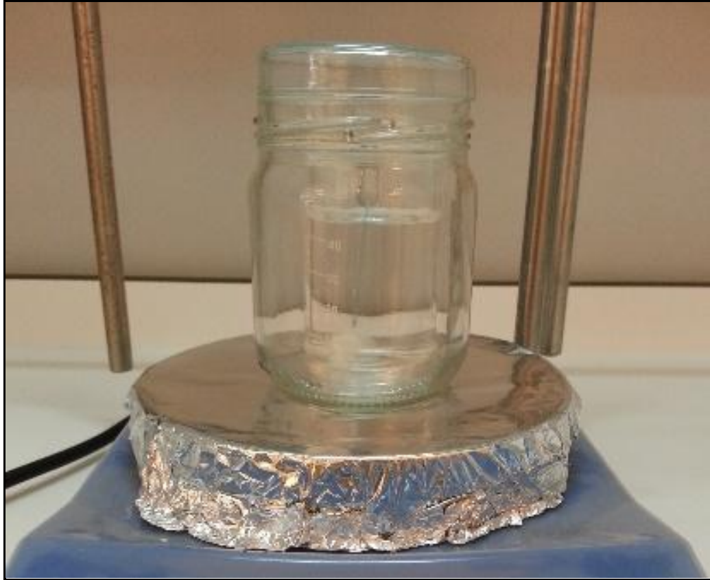
Şekil 5.10: Polimerik yapılara MTCS kaplanarak yapılan sıvı faz kaplama deney düzeneği.
