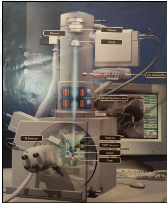
Şekil 4.19: SEM cihazı blok diyagramı.
