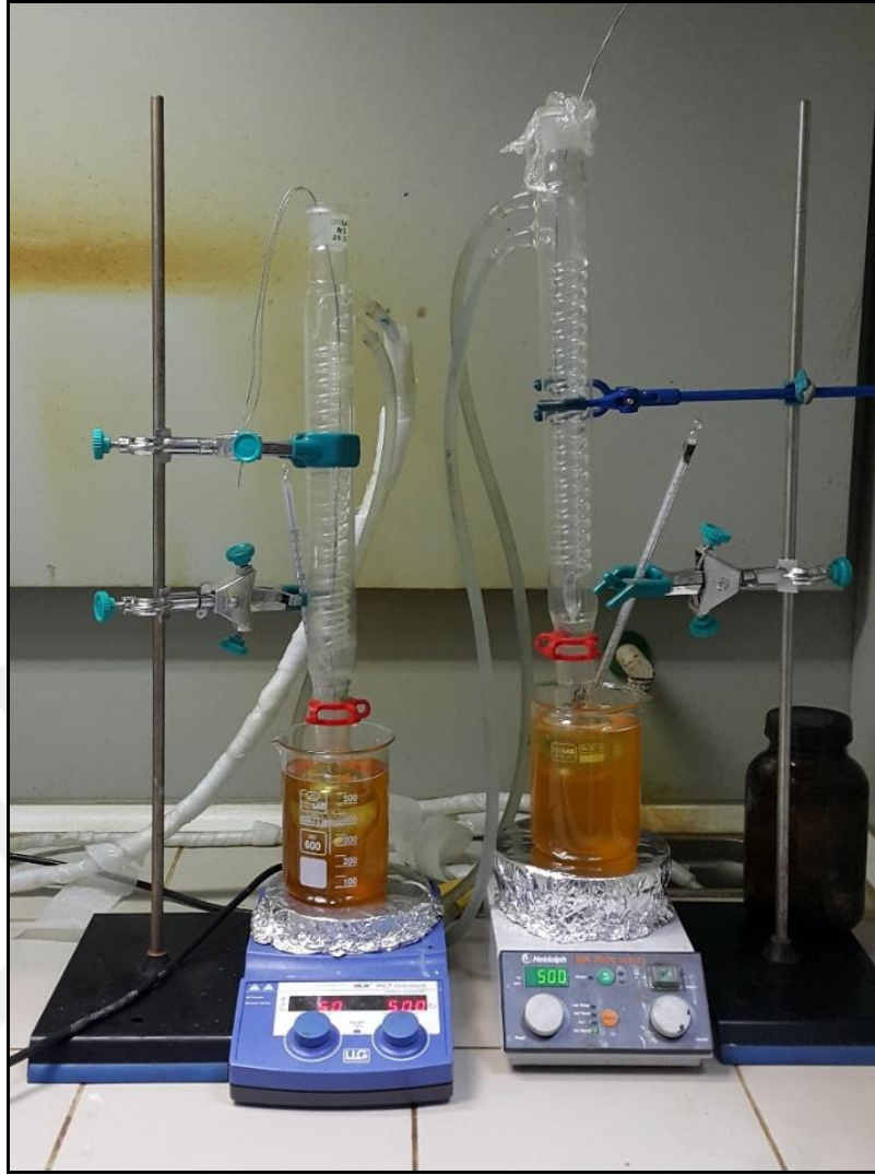
Şekil 4.14: Organosilan ısıtılarak sıvı faz kaplama deney düzeneği.
