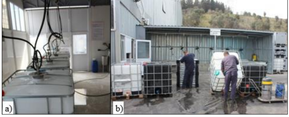
Şekil 2.2: a) Konteyner yıkama istasyonu, b) konteynerlerin yıkanması.
