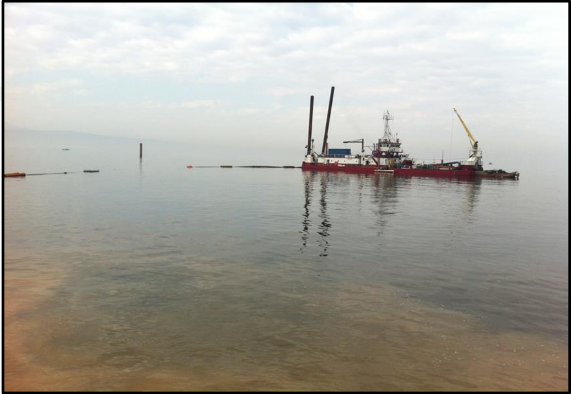
Şekil 3.2: Deniz tabanı gevşek kum taramasını gerçekleştiren aracın görüntüsü.
