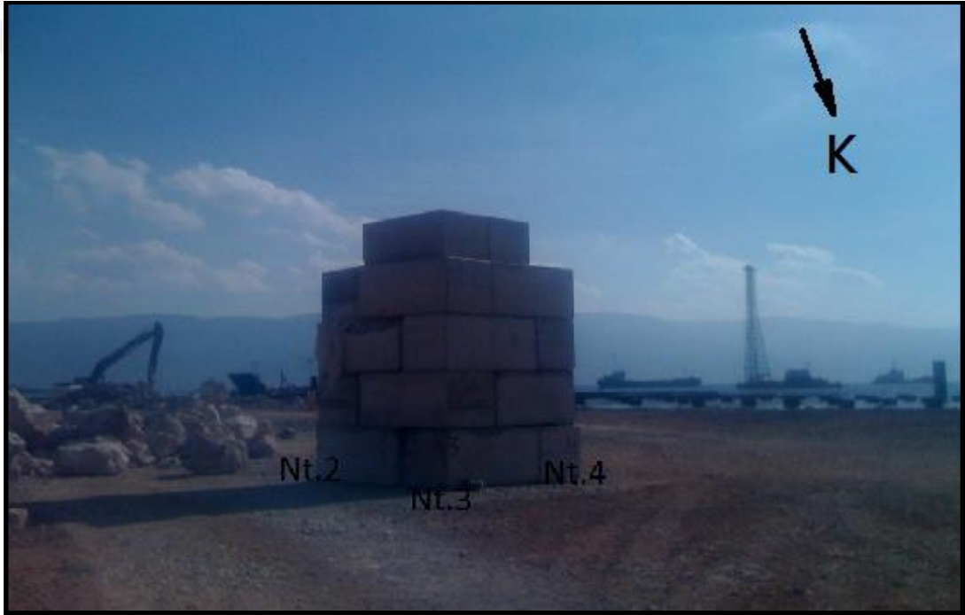
Şekil 6.9: Beton Blok Yükleme Deneyi-1'in görünümü.
