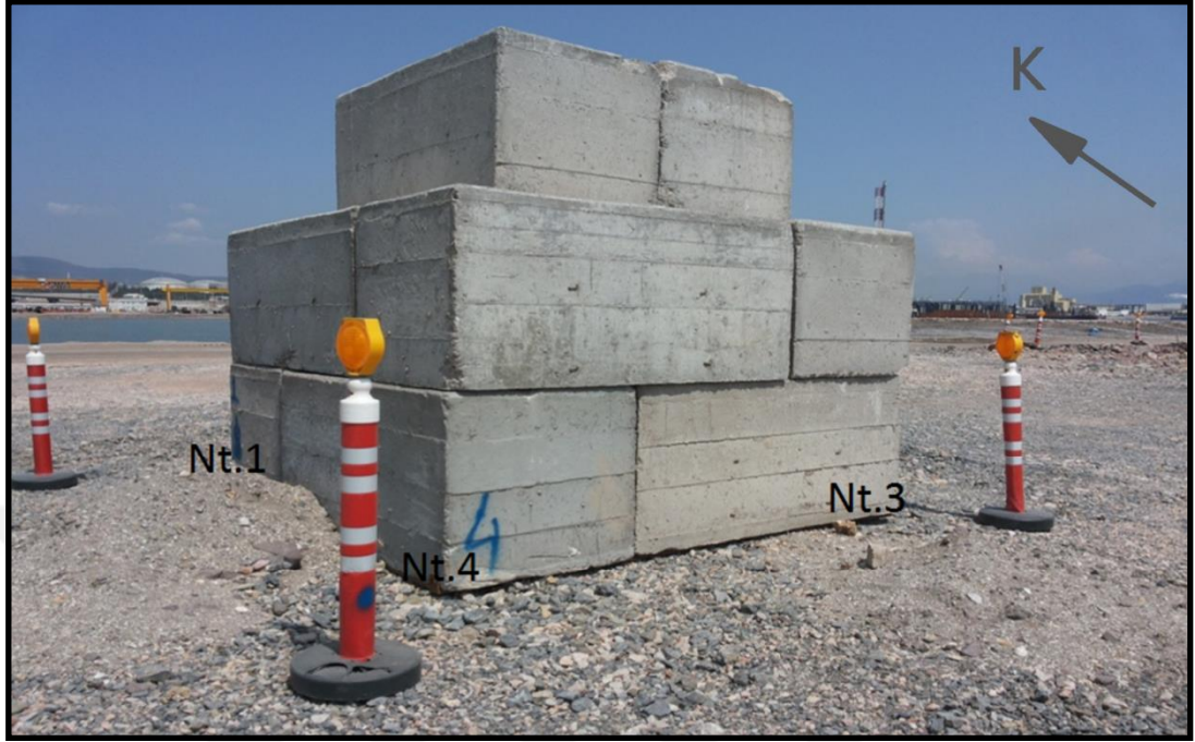
Şekil 6.11: Beton Blok Yükleme Deneyi-2'nin görünümü.
