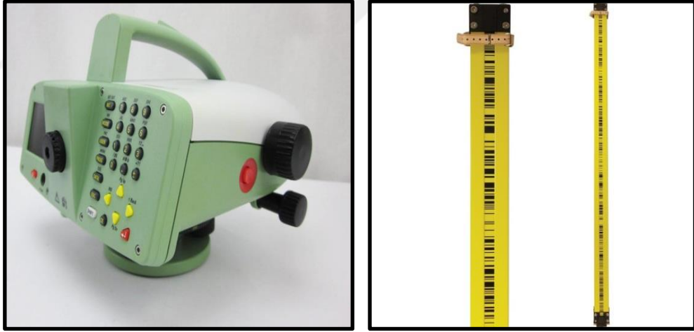
a) b) Şekil 5.2: a) Leica DNA03 Nivo ve b) GPCL3 İnar mira.
