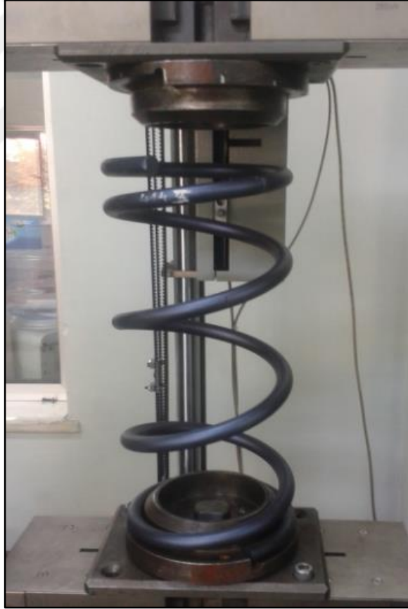
Şekil 3.7: Meneviş fırınından alınmış bir helisel yayın bloklama deneyine başlamadan önceki görünümü.
