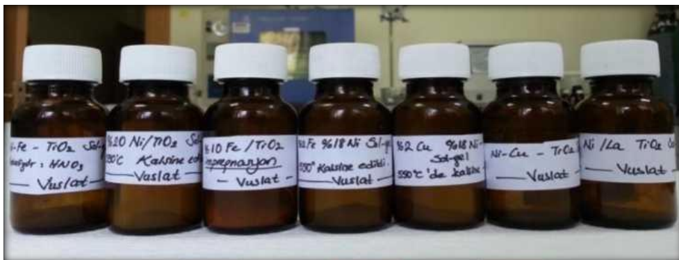
Şekil 2.5: Solgel yöntemi ile sentezlenen metal katkılu TiO_2 kompozitleri.
