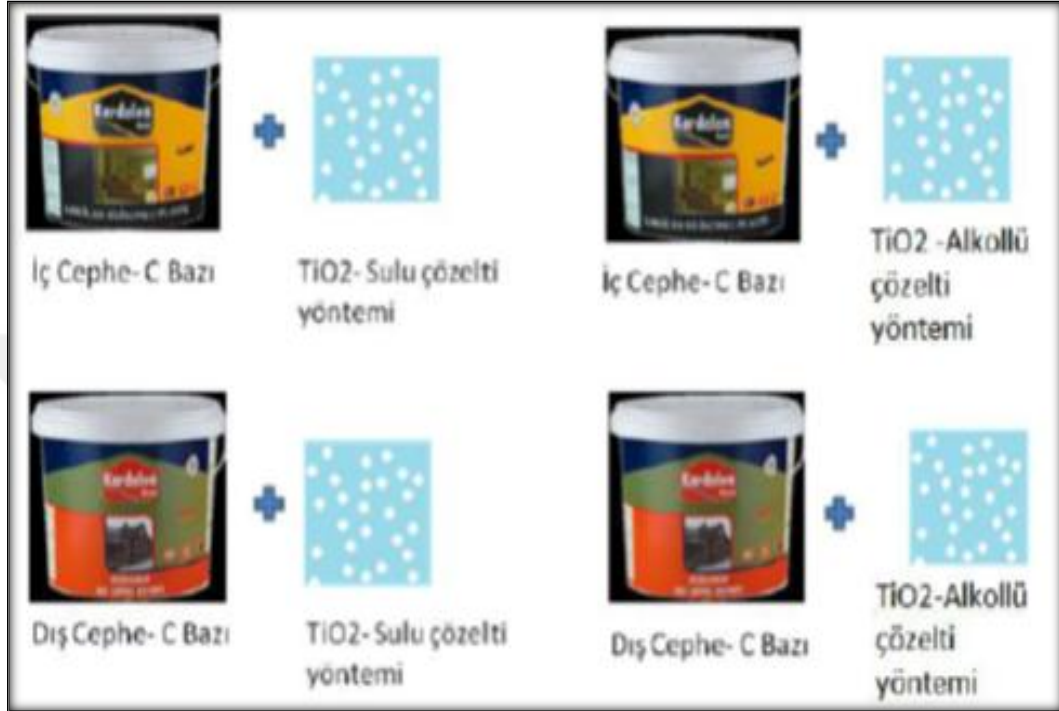
Şekil 2.9: Sentezlenen TiO_2 nano tozlarının C boya bazı içinde davranışlarının incelenmesi için kurulan deney seti.
