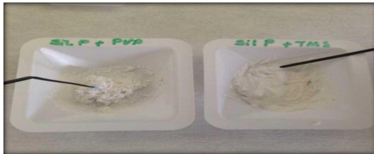
Şekil 4.2: PVP ve TMS kimyasallarının C boya bazı içinde toplanma davranışlarının karşılaştırılması.
