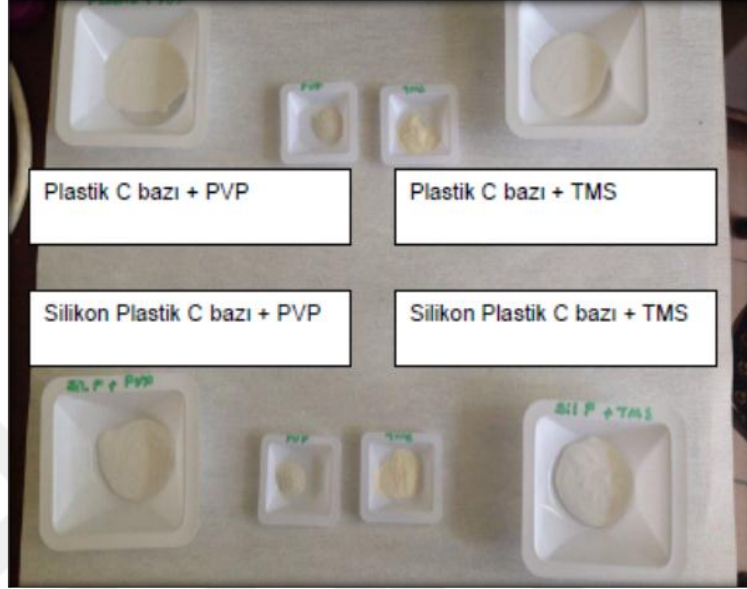
Şekil 4.1: PVP ve TMS kimyasallarının C boya bazı (plastik, silikon plastik) içindeki davranışı incelenmesi için oluşturulan deney seti.
