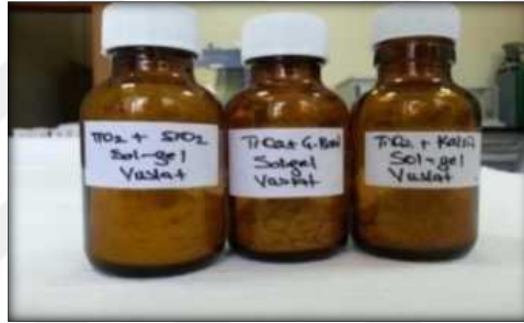
Şekil 2.4: Solgel yöntemi ile sentezlenen mineral katkılu TiO_2 kompozitler.
