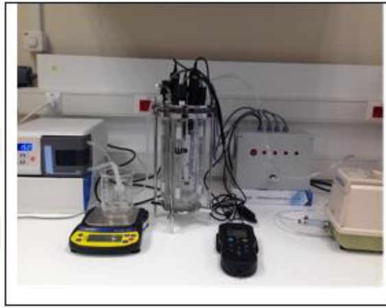
Şekil 3.3: Tezgah-üstü İleri Oksidasyon Prosesi/Batık Ultrafiltrasyon (İOP/ UF) Hibrit Reaktörü.
