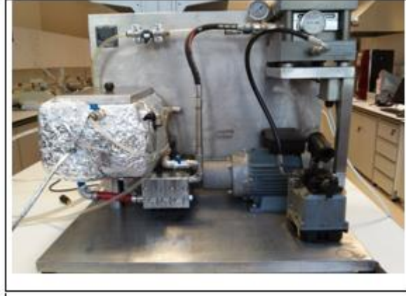
Şekil 3.2: Sürekli İşletimli Basınç Sürücülü Membran Prosesi.
