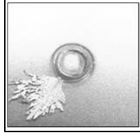
Şekil 2.11: Kaynak Ara Yüzeyinde Meydana Gelen Fıskırma.
