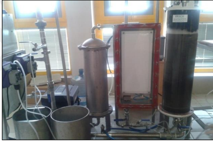
Şekil 3.2: Jet döngülü biyoreaktörde NO x giderim sistemine ait fotoğraf.
