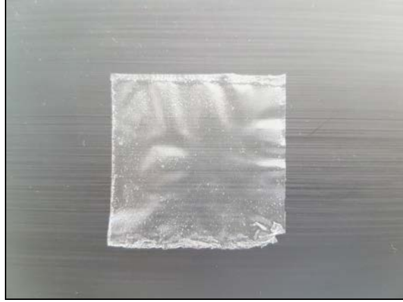
Şekil 3.9: %10'luk İmidazol fonksiyonel nano parçacıklarıyla hazırlanmış Nafyon kompoziti proton iletken membran.
