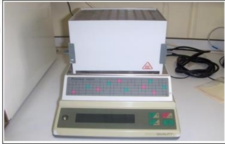
Şekil 5.7: Precisa HA60 nem ölçme cihazı.
