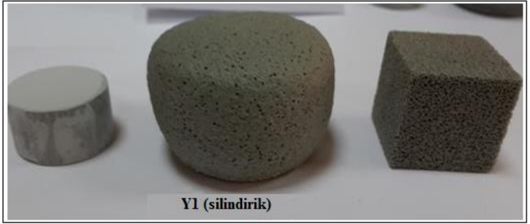
Şekil 6.8: Y1 silindirik numunesinin sinter öncesi, sinter sonrası ve kenarları kesilerek elde edilmiş köşeli ürününün görüntüsü.
