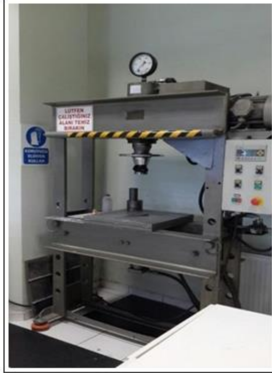
Şekil 6.3: Deneysel çalışmalarda kullanılan hidrolik pres cihazı.
