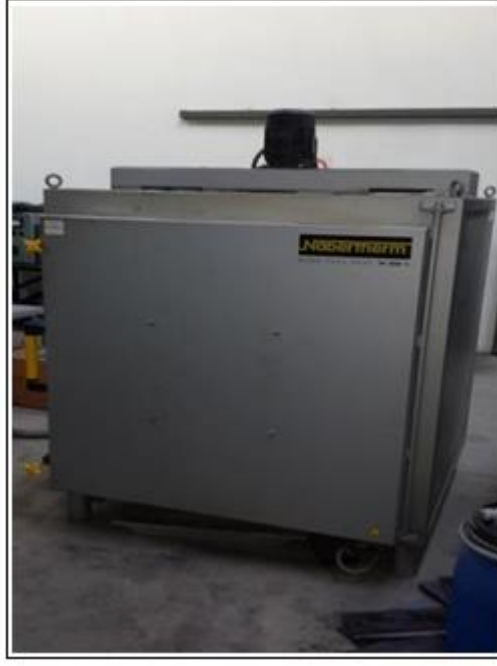
Şekil 6.5: NABERTHERM marka N500/85A model hava sirkulasyonlu fırın.
