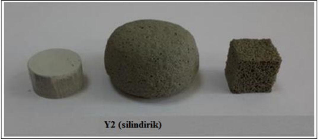
Şekil 6.9: Y2 silindirik numunesinin sinter öncesi, sinter sonrası ve kenarları kesilerek elde edilmiş köşeli ürününün görüntüsü.
