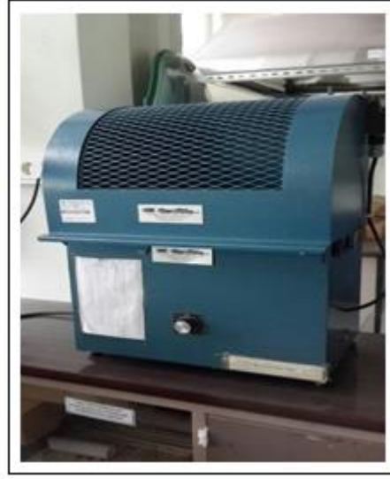
Şekil 6.1: Karıştırma işleminde kullanılan bilyalı değirmen.
