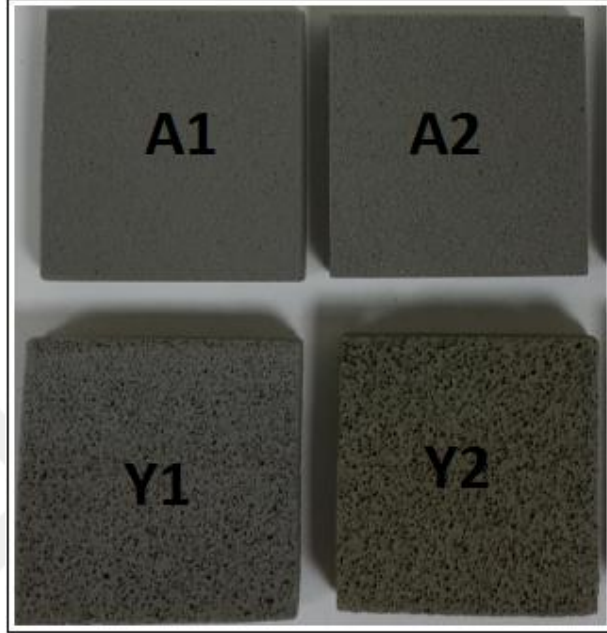
Şekil 6.17: Isıl iletkenlik analizi için 500 kg/cm 2 basınçta preslenmiş numunelerin görüntüsü.
