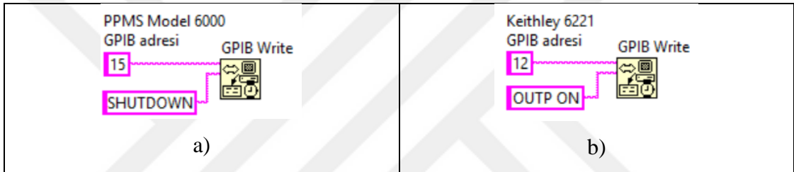
Şekil C1. 1: a) PPMS Model 6000 ve b) Keithley 6221 cihazları için “GPIB write” fonksiyonunun kullanımı.
