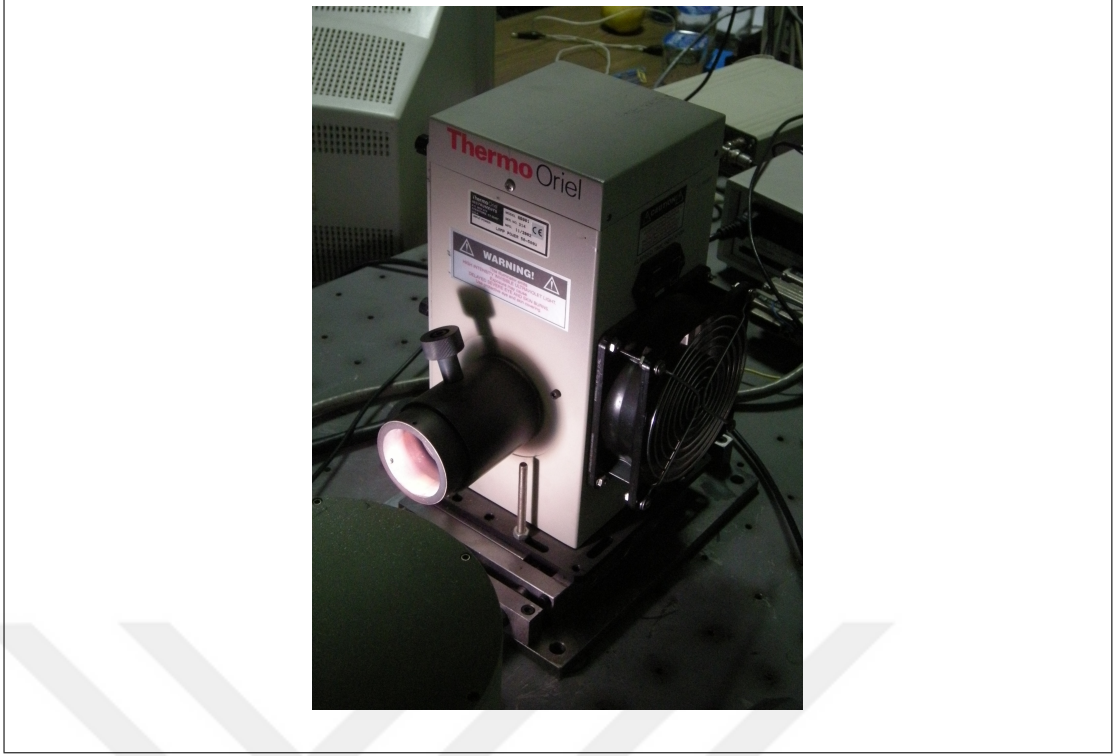
Şekil 4.1: Thermo Oriel Zenon lambanın çalışır haldeki görünümü.
