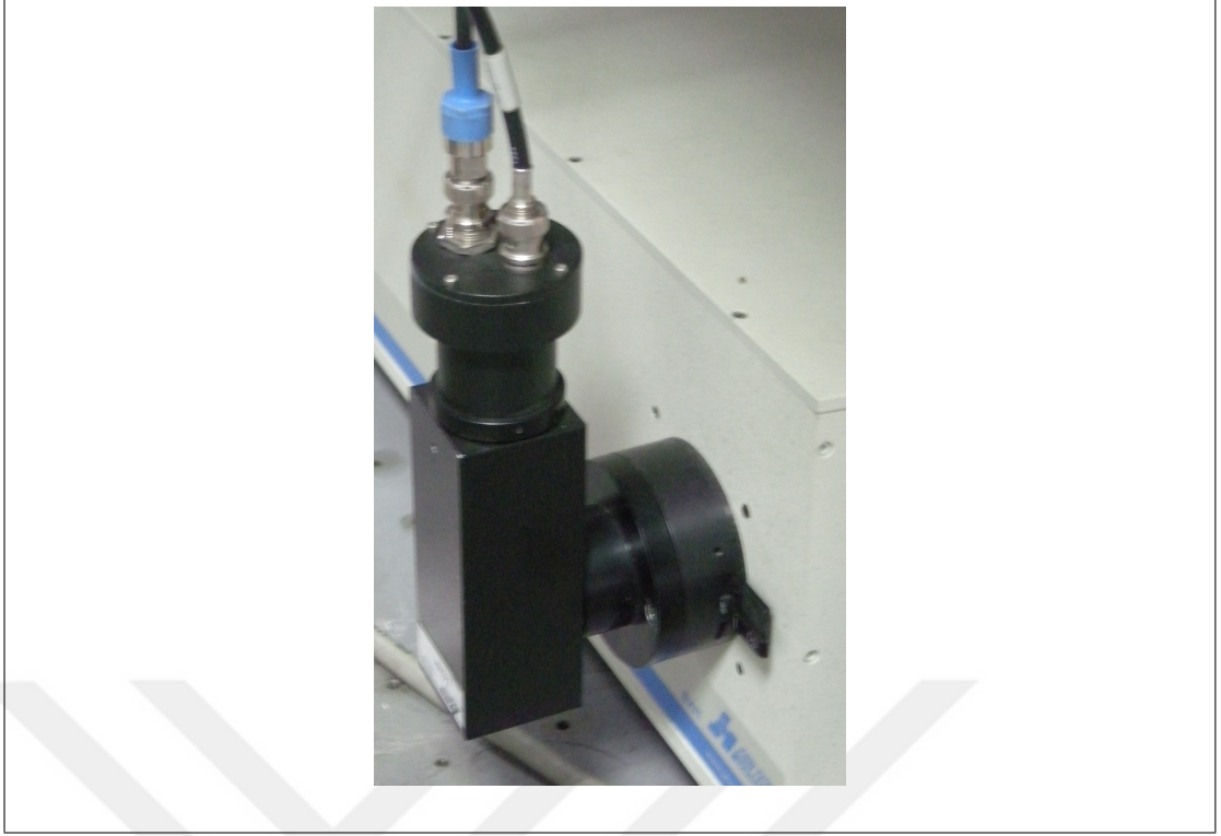
Şekil 4.8: Fotoçoğaltıcının monokromatör üzerinde duruşu.
