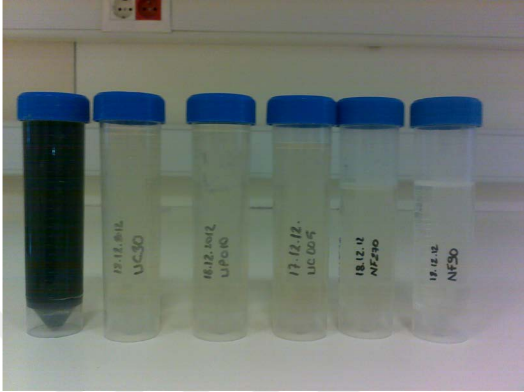
Şekil 4.8: Sol baştan sırasıyla ham numune ile UC 030, UP 010, UC 005, Nf 270, Nf 90 süzüntüleri.
