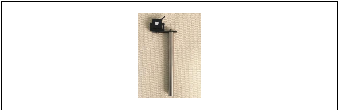
Şekil 3.11: P-MOKE ölçümleri için kullanılan manyetik olmayan saf Si ayna.
