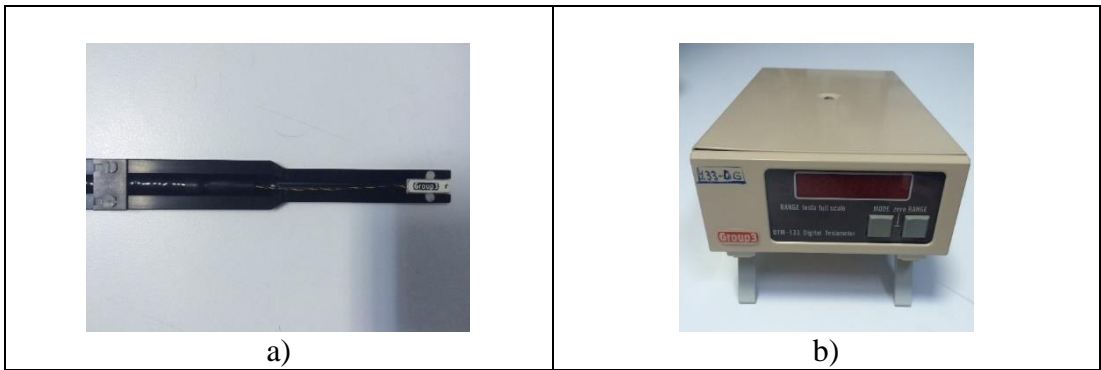
Şekil 3.18: MOKE sisteminde kullanılan a) manyetik alan sensörü ve b) dijital teslametre.
