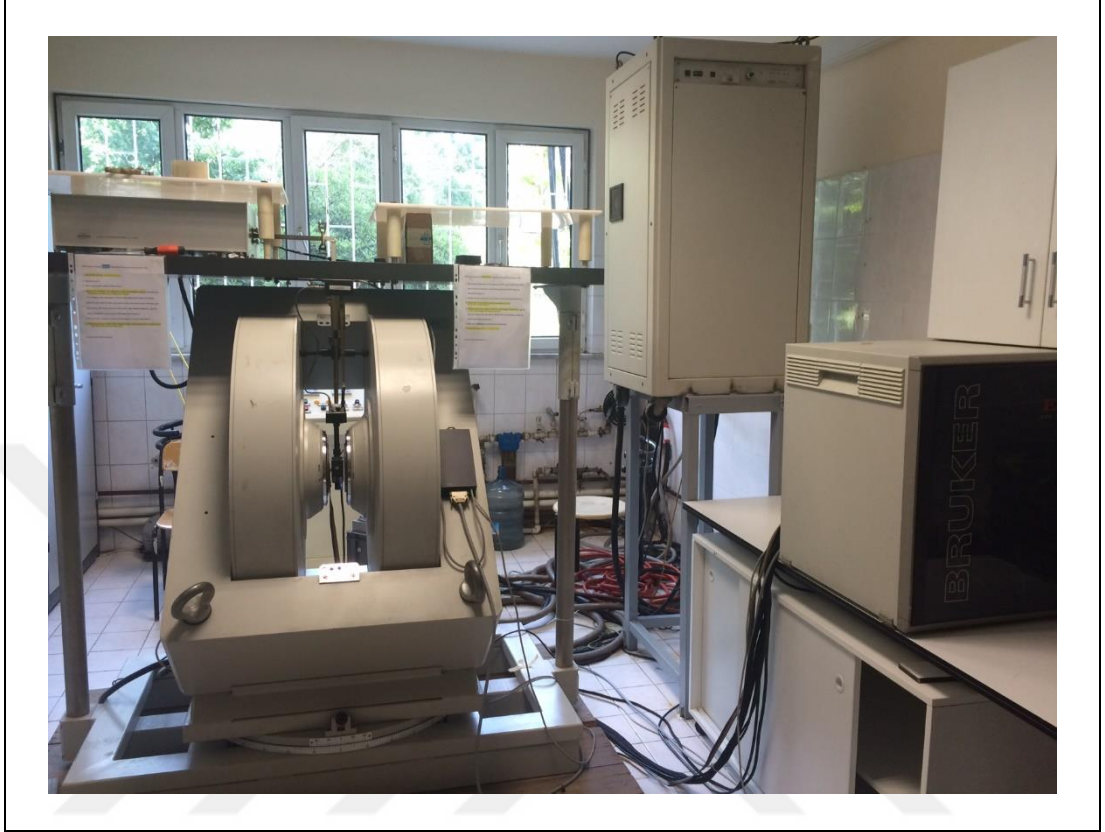
Şekil 4.14: Gebze Teknik Üniversitesi Fizik Bölümü laboratuvarında bulunan Bruker EMX model ESR cihazı.
