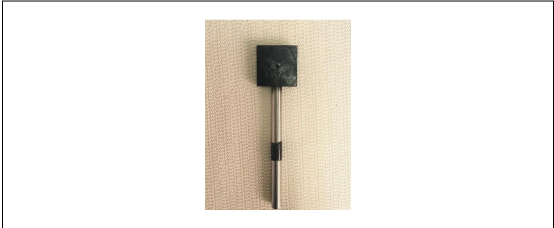
Şekil 3.14: MOKE sisteminde kullanılan 1 mm çapındaki hizalama deliği (pin hole).
