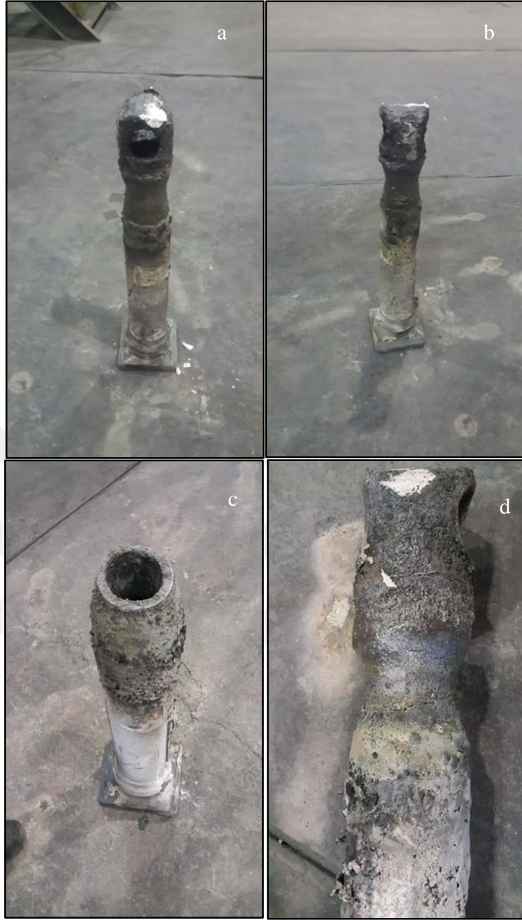
Şekil 4.2: Çolakoğlu Metalurji firmasından temin edilen kullanılmış daldırma nozul; a) önden, b) yandan, c) üstten, d) yatay görünüm.
