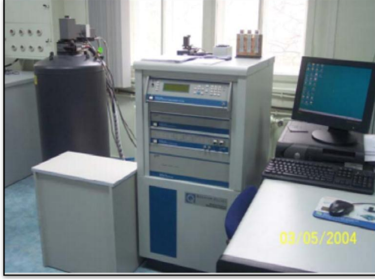
Şekil 3.13: Mıknatıslanma ölçümlerinde kullanılan PPMS.
