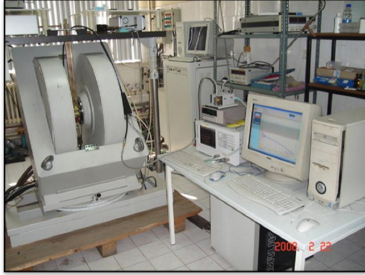
Şekil 3.14: Manyetik rezonans ölçüm düzeneğinin resmi.
