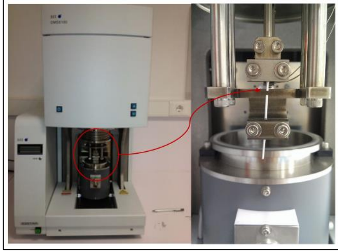
Şekil 3.9: Mekanik dayanım ölçme cihazı ve kopma anı.
