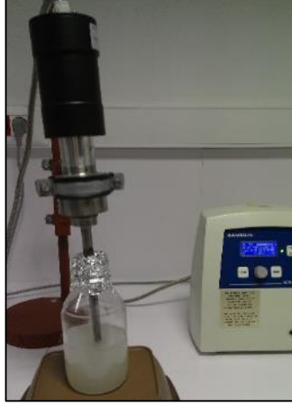
Şekil 3.3: NMP içerisinde HNT' nin sonikatör ile homojenizasyonu.
