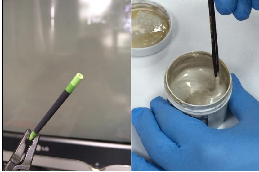
Şekil 3.18: Üç Katmanlı Yakıt Hücresi (Solda) ve Gümüş Pasta (Sağda).
