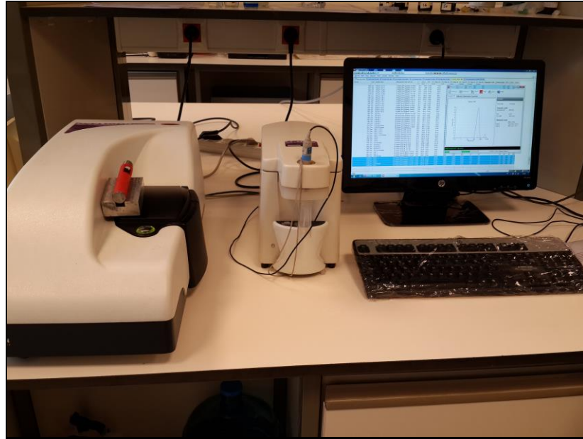
Şekil 4.1: Tane Boyut Analiz Cihazı.
