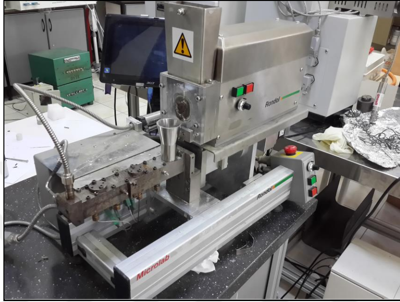
Şekil 3.1: GTÜ Nanoteknoloji Enstitüsü’nde kurulan mini ko-ekstrüder cihazı.
