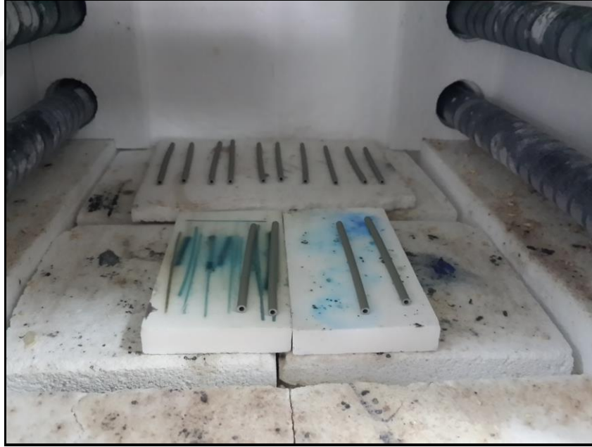
Şekil 3.6: Ekstrüzyon yöntemiyle üretilen boru tipi anot (NiO-YSZ) hücrelerinin 1200 °C sıcaklıkta sinterlenme öncesi hali.
