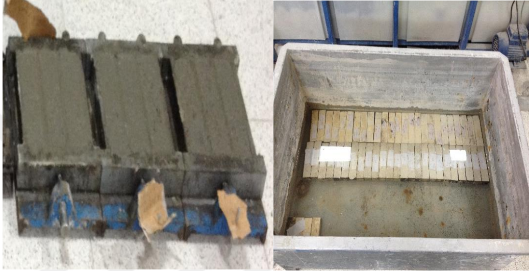
Şekil 3. 1. Deney örneklerinin kalıplara yerleştirilmesi ve bekletilmesi
