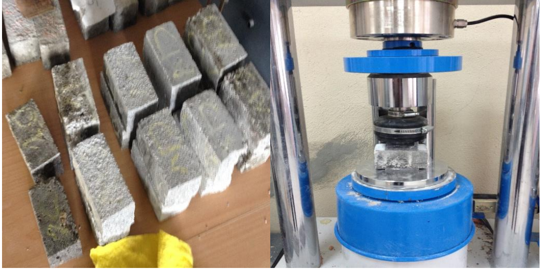
Şekil 3. 9. Basınç dayanımı deneyi için hazırlanan numuneler ve deney düzeneği
