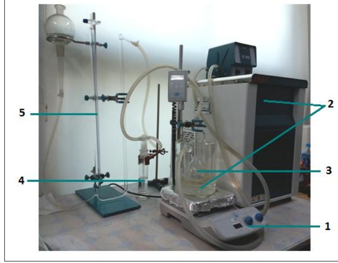
Şekil 5.1: Hidrojen üretim miktarlarının ölçülmesinde kullanılan düzenek. 1. Manyetik karıştırıcı 2. Sıcaklık ayarlı su banyosu 3. Reaktör 4. Gaz yıkama şişesi 5. Gaz büreti.
