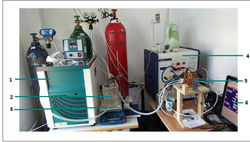
Şekil 6.29: PEM testlerinde kullanılan düzenek. 1) Dıştan sirkülasyonlu su banyosu, 2) Reaktör 3) Sıcaklık kontrolünü sağlayan ceket 4) PEM yakıt hücresi test istasyonu 5) PEM yakıt hücresi 6) Kontrol bilgisayarı.
