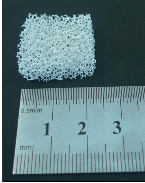
Şekil 3.2: Sünger yapılu ZnO katalizör.
