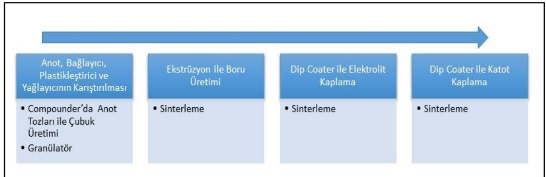
Şekil 4.1: Üretim akış şeması.
