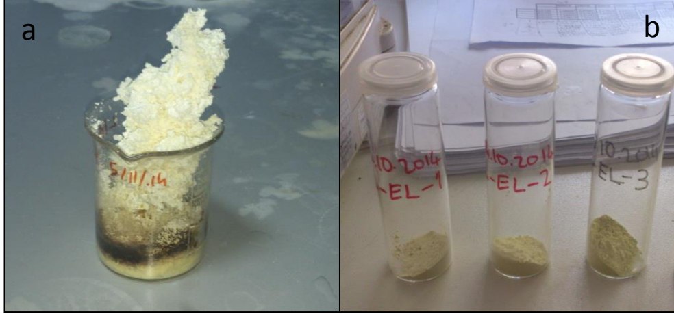
Şekil 4.2: GNP metoduyla elde edilen elektrolit tozları. a) Sentez sonrası aglomere hali ve b) topaklanmanın dağıtılmış hali.
