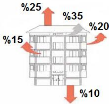
Şekil 2.1. Binalarda ısı kaybı gerçekleşen bölgeler
