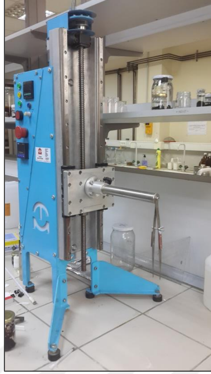
Şekil 5.5: Daldırarak kaplama cihazı (dip coater).
