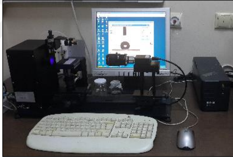
Şekil 5.7: KSV CAM-200 temas açısı ölçüm cihazı.
