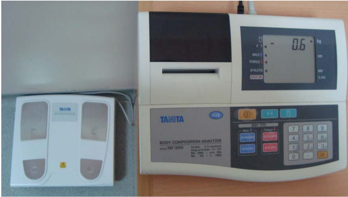
Şekil 4. Sadece ayaklardan ölçüm yapan Bioelektriksel İmpedans analiz sisteminin kullanıldığı cihaz (Tanita Body Composition Analyser; TBF 300, Tokyo, Japonya).
