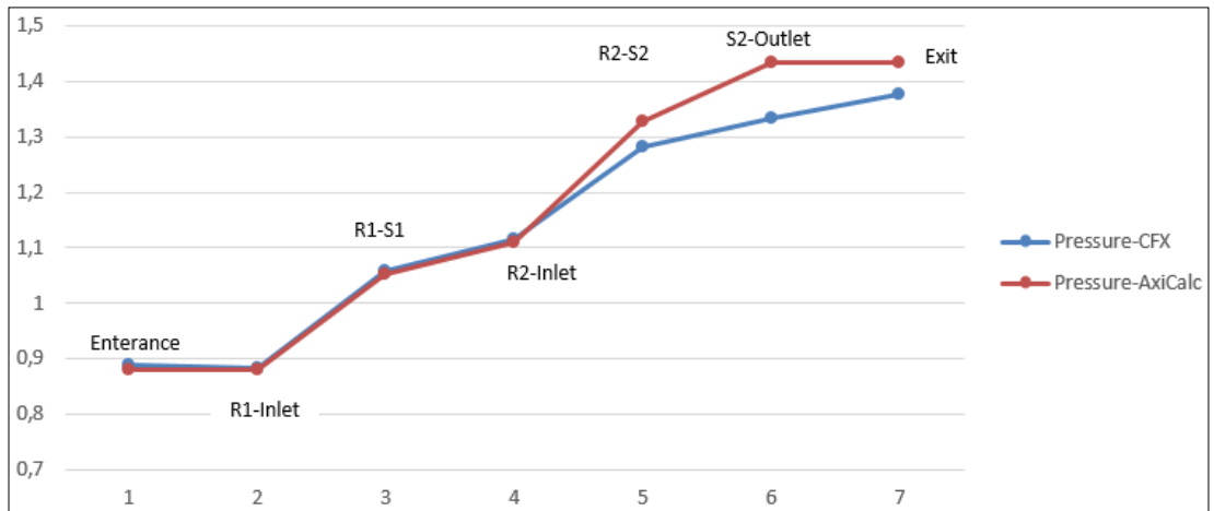
Şekil 4.26: HAD ve AxiCalc statik basınç sonuçları, k-ε modeli.
