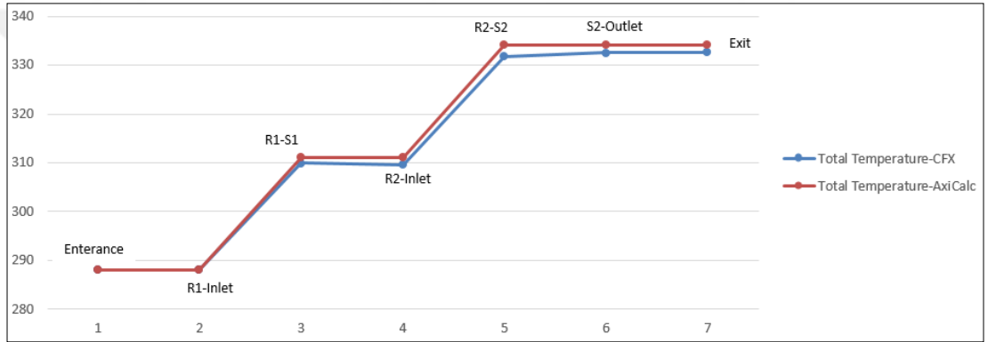
Şekil 4.25: HAD ve AxiCalc toplam sıcaklık sonuçları, k-ε modeli.
