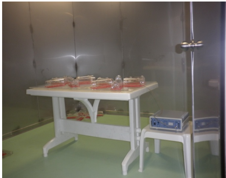
Şekil 6. Çelik tabakalarla tamamen dış ortam radyasyonundan izole edilmiş çalışma odası.
