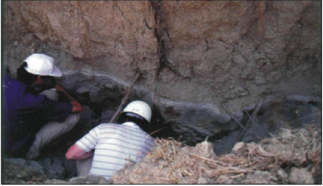
Foto 4: Sıvılařma Esnasında Yüzeğe ıkamayan Kum Seviyesi (Adana Valilięi İl Afet Acil Yardım Komitesi Raporu ,1998:62).
