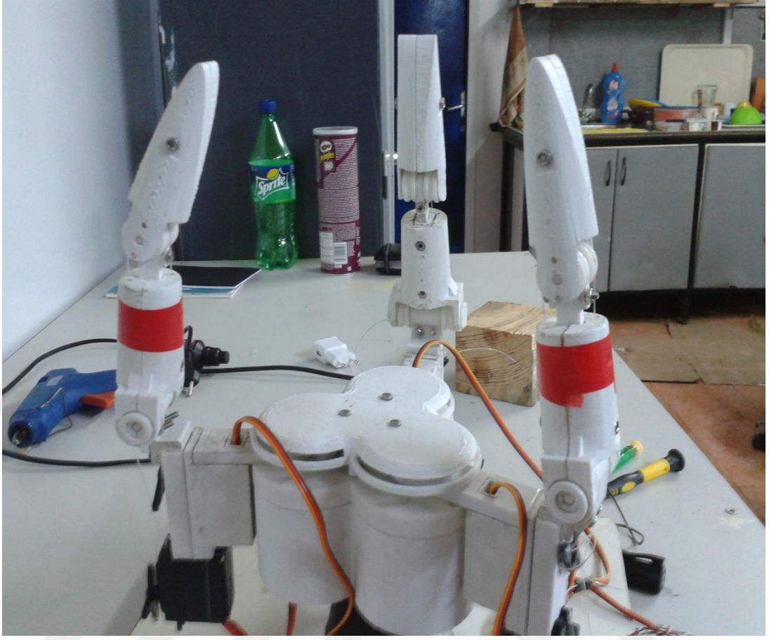
Şekil 3.2: 3 Parmaklı Kavrayıcı Robot El Son Tasarımı.
