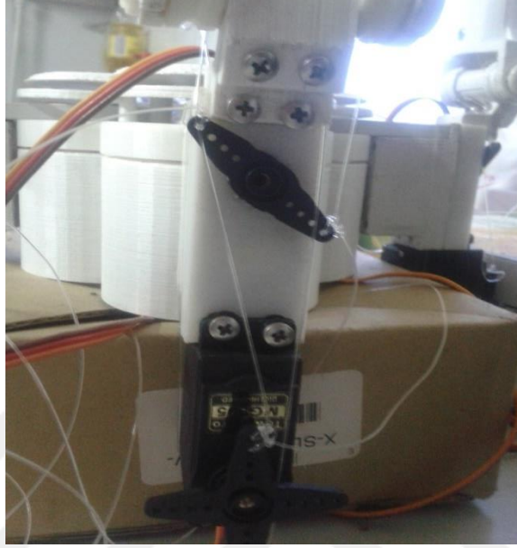
Şekil 3.1: Burkulma hareketi için eklenen servo motorlar.
