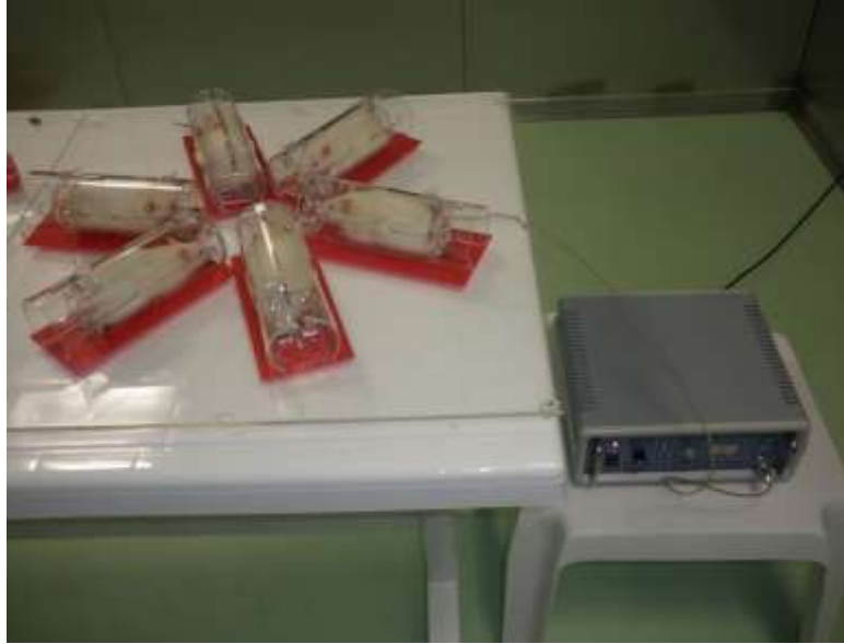
Şekil 6. Radyofrekans oluşturan cihazla birlikte deneklerin maruziyet esnasındaki görüntüsü
