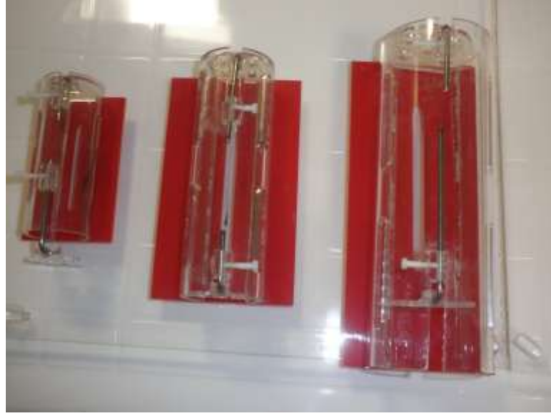
Şekil 5. Deney için kullanılan çeşitli boyutlarda flexiglass kafesler
