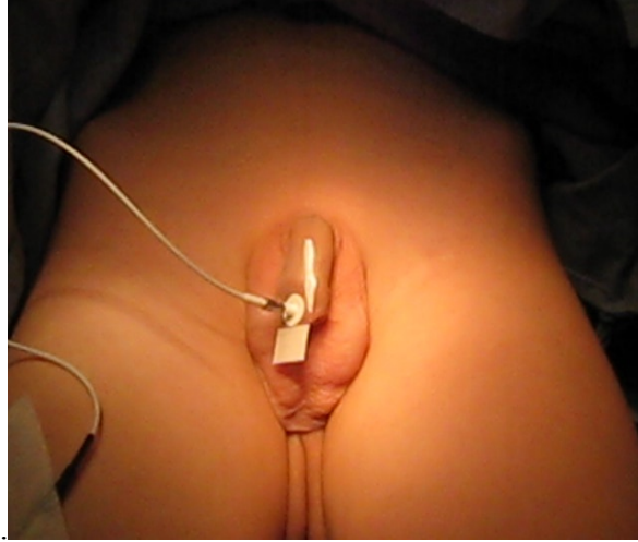
Şekil 11. Lazer Doppler cihazının probu ve çift yönlü şeffaf bant kullanılarak ölçüm yapılması
