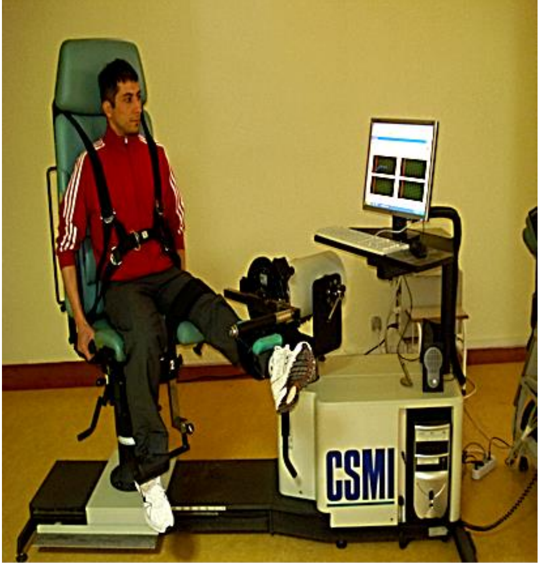
Resim 4. İzokinetik Dinamometrede Diz Fleksiyon ve Ekstansiyon Testi
