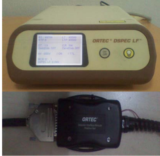
Şekil 3.6. DSPEC LF (üstte) ve yüksek gerilim modülü (altta)
