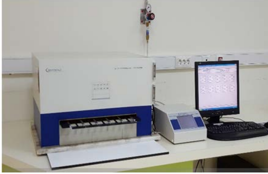
Şekil 3.16. Berthold LB 770-PC 10-Kanal düşük seviye sayım sistemi
