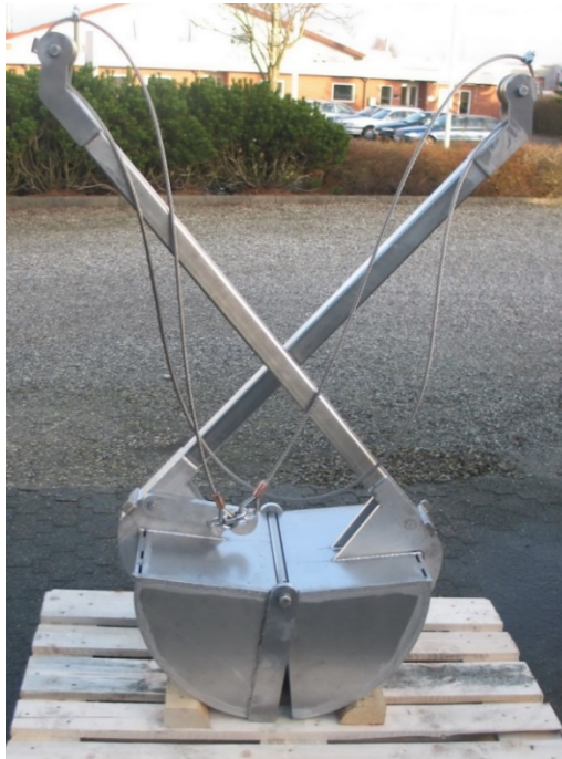
Şekil 3.9. Van Veen sediment toplama ekipmanı
