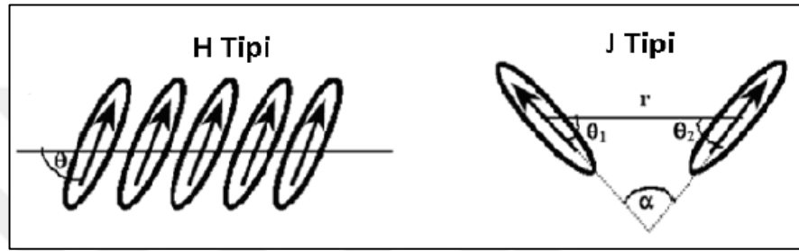
Şekil 2. 6: Ftalosiyanimlerdeki agregasyon tipleri.
