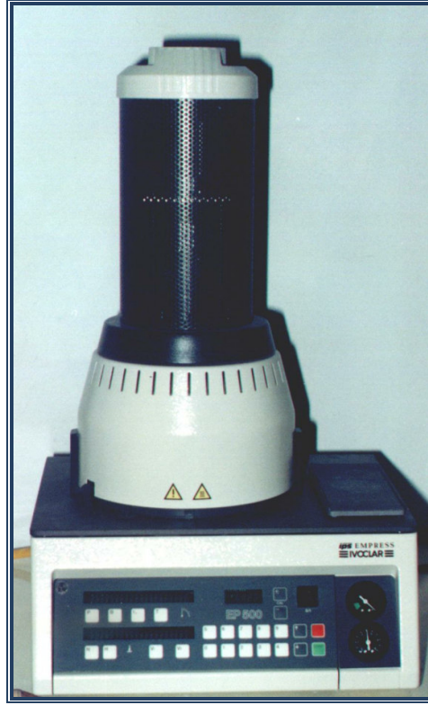
Şekil 2. IPS Express Ivoclar EP 500 porselen fırını
