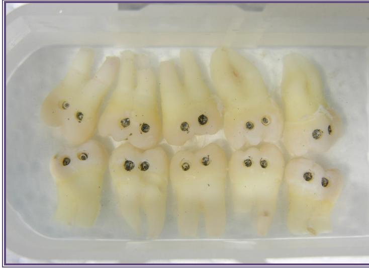
Şekil 5. Beş dişin ikiye kesilmesiyle elde edilen bir bağlantı deney grubu
