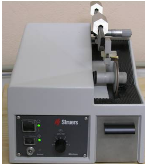
Şekil 5. Dişleri kesmek için kullanılan su soğutmalı kesit cihazı
