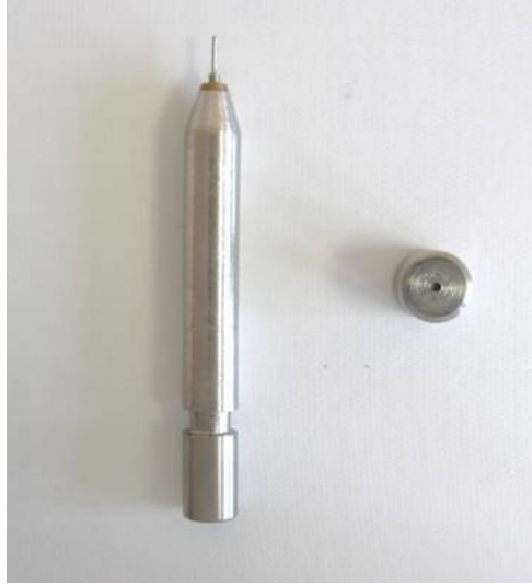
Şekil 8. Kuvvet uygulayan ve dentin diskinin yerleştirildiği parçalar
