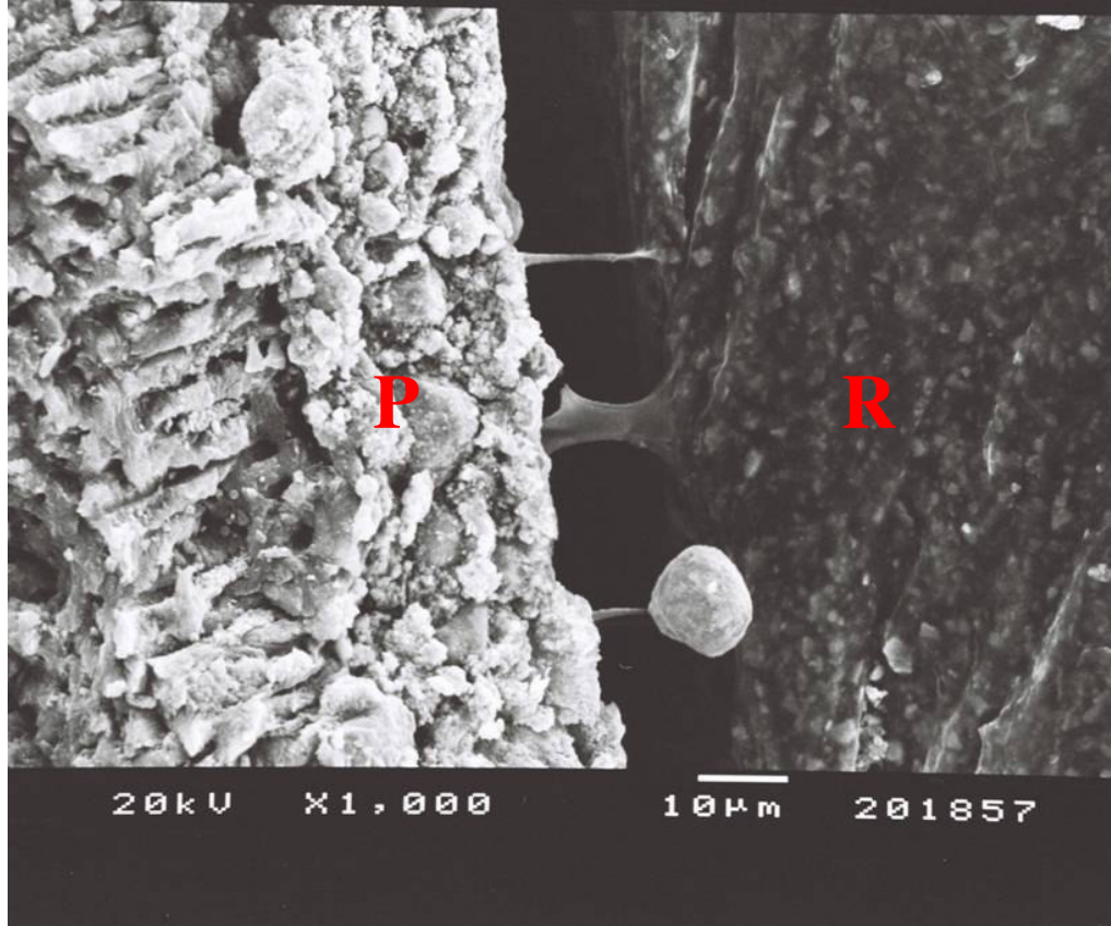
Şekil 40. Resilon/Ketac-Endo/soğuk lateral kompaksiyon grubu (C2)'ye ait örneğin SEM mikrografı (X 1000), P: Kanal patı, R: Resilon
