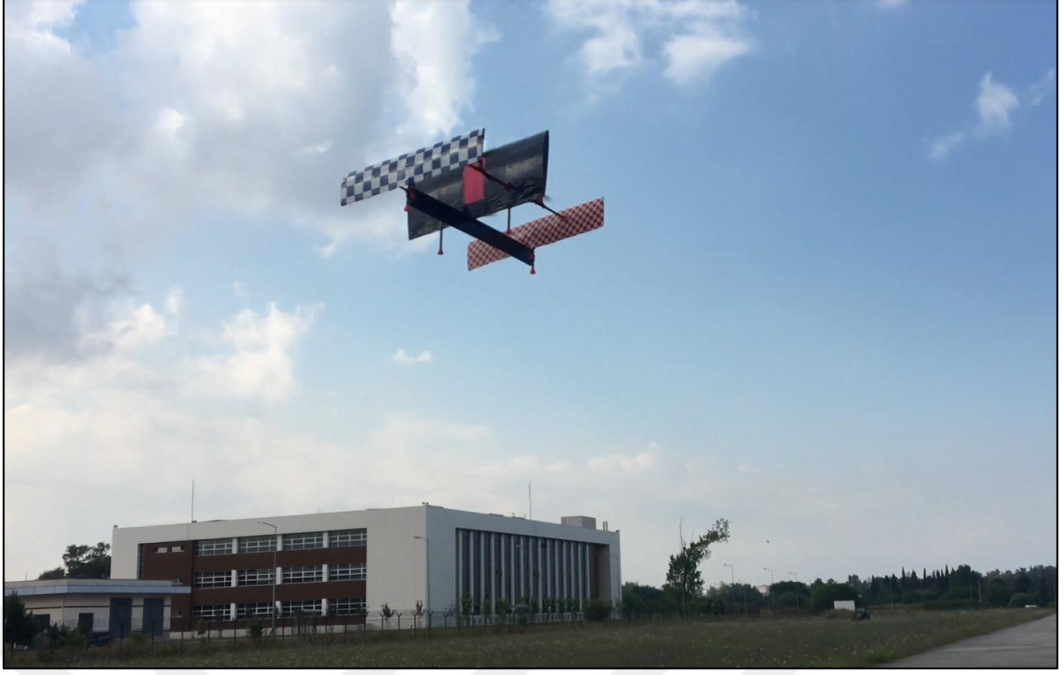
Şekil 5.2: TriPlane aracının döner kanat modunda yükselişi.
