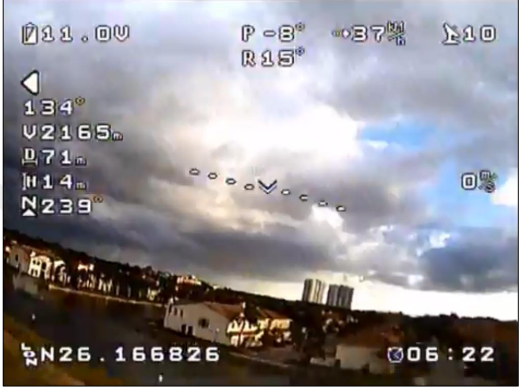
Şekil 2.16: OSD kamera süperpozisyonu.
