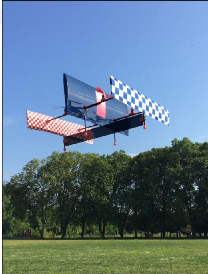
Şekil 5.1: TriPlane aracının döner kanat modunda ( hover ) uçuşu.
